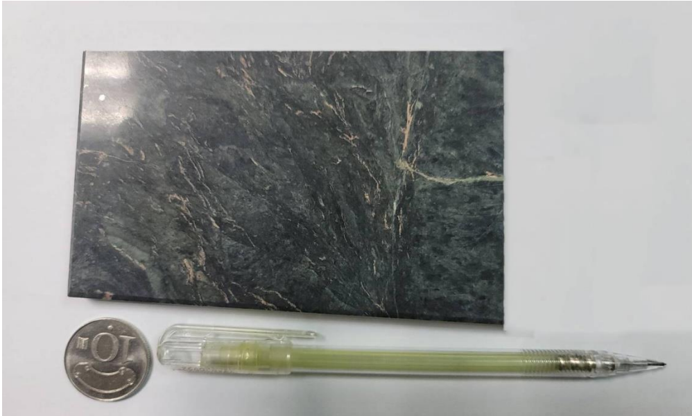
圖 4 台灣墨玉厚度 1 公分，在高溫爐以攝氏 400 度加熱 1 小時，直接升溫至 500 度再加熱 1 小時，而後再升溫至 618 度加熱 1.2 小時，合計連續加熱 3.2 小時，台灣墨玉沒有產生裂痕。
