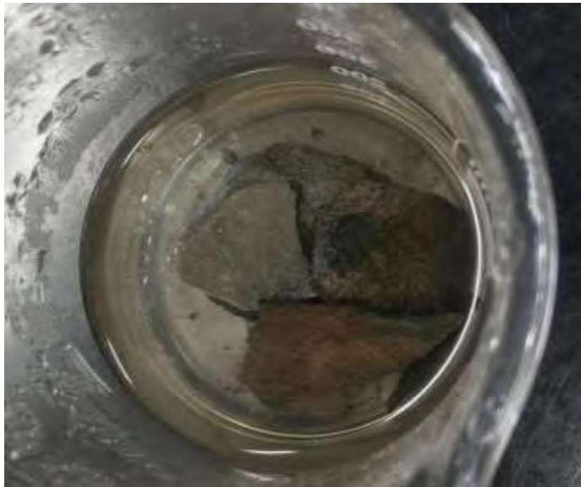
圖 13-3 板岩加熱後置於水中，水質尚清澈，但水中有產生碎屑。
