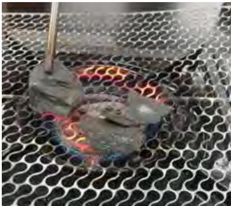
圖 12 岩石燒裂情形，板岩於加熱過程中燒裂。
