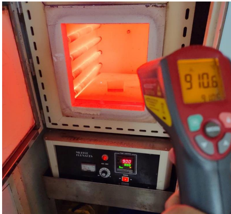
圖 5 台灣墨玉以高溫爐加熱至攝氏 910 度。
