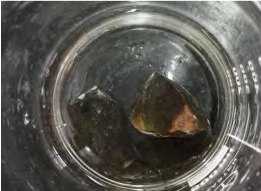
圖 13 蛇紋石(台灣墨玉)加熱後置於水中，水質清澈，水中沒有產生碎屑。
