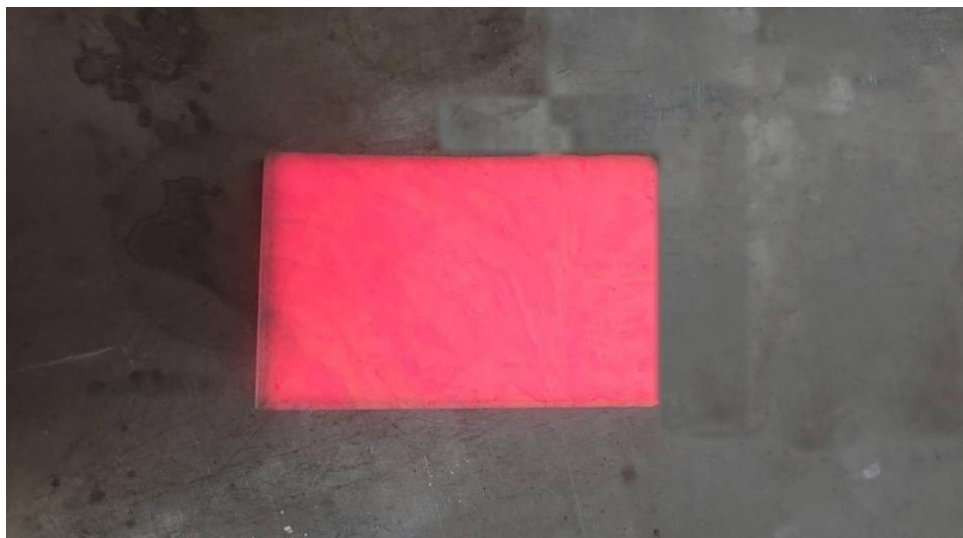
圖 6 台灣墨玉從攝氏 910 度高溫爐中取出，燒成紅色，沒有裂痕。
