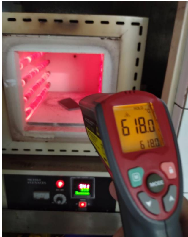
圖 3 台灣墨玉以高溫爐加熱至攝氏 618 度。
