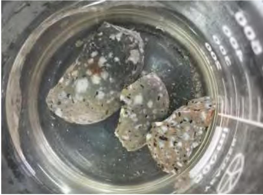
圖 13-2 斑狀安山岩(麥飯石)加熱後置於水中，水質清澈，但水中有產生碎屑。
