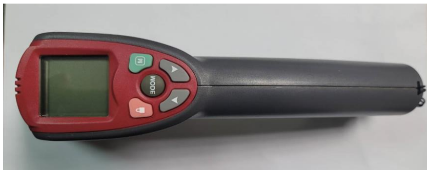
圖 2 測溫槍可測量溫度達攝氏 1200 度。
