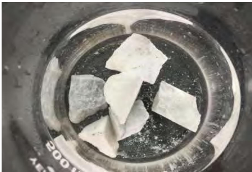
圖 13-4 大理岩加熱後置於水中，水質混濁，水中有產生碎屑。
