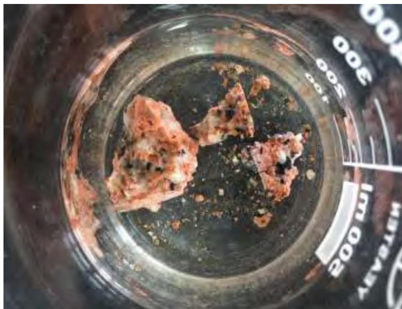
圖 13-1 花崗岩加熱後置於水中，水質尚清澈，但水中有產生碎屑。
